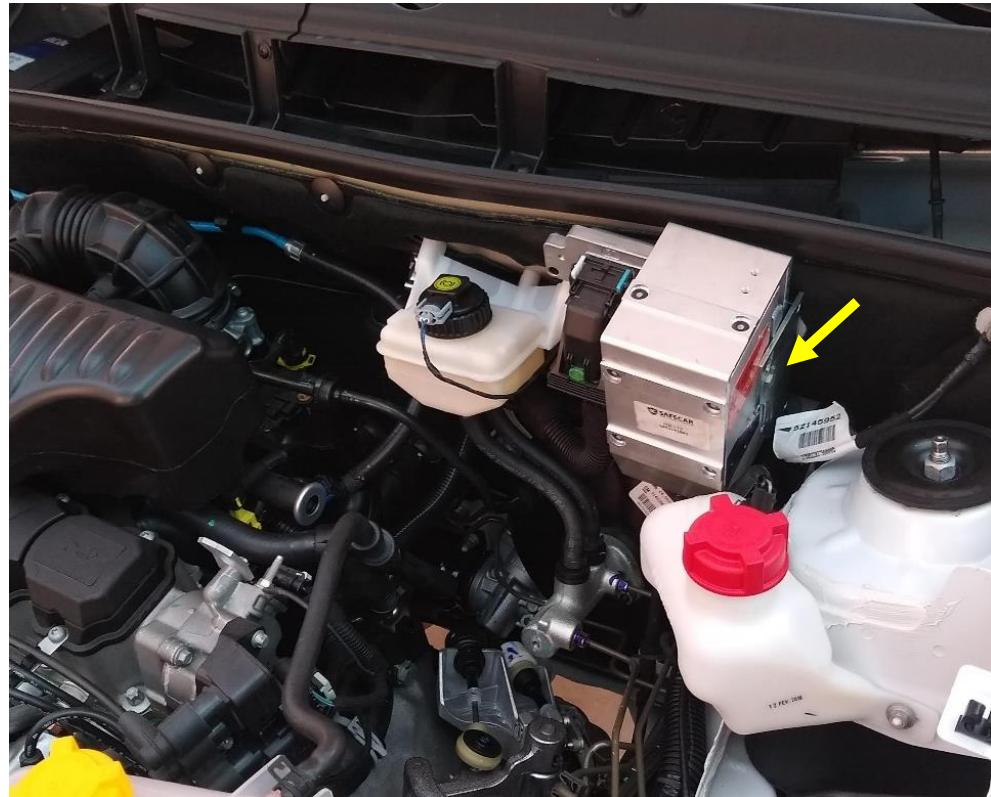
13. Verificar se o cofre não está vibrando ou encostando em outros componentes do veículo.
