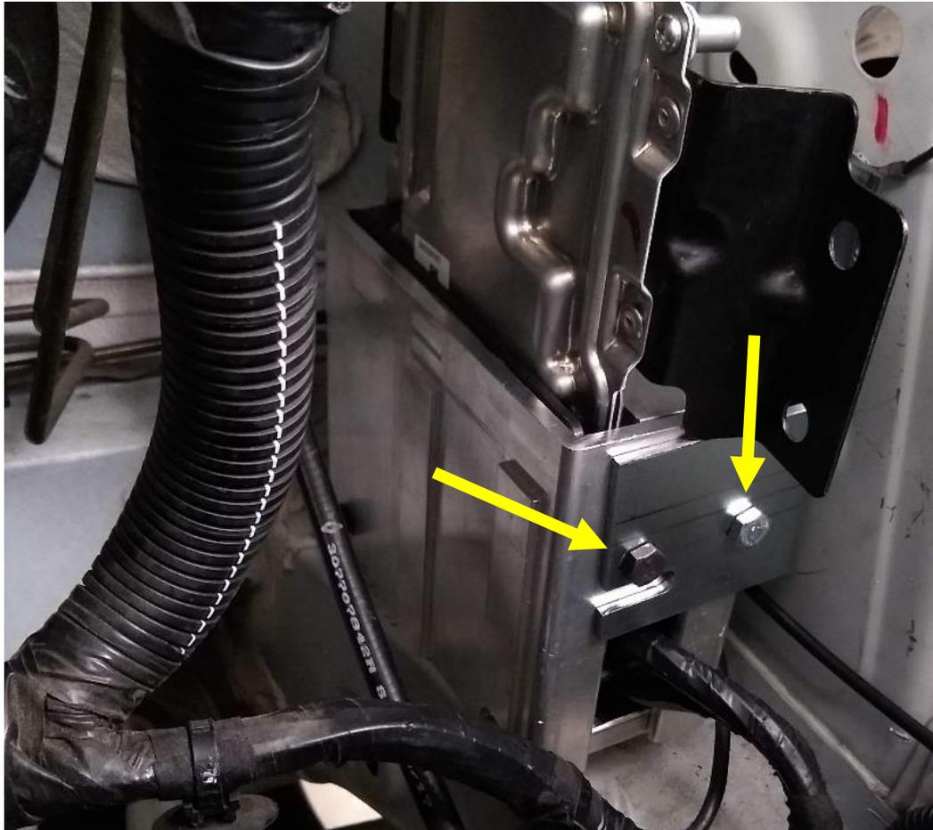
9. Fixar bateria na posição original e verificar a fixação dos componentes.
